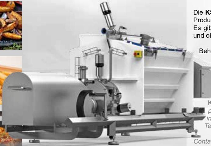
Die **KS** Zuführbehälter werden zur Weiterförderung des Produktes in eine angeschlossene Maschine eingesetzt. Es gibt sie in Kunststoff- oder Edelstahlausführung mit und ohne Teflonbeschichtung.
