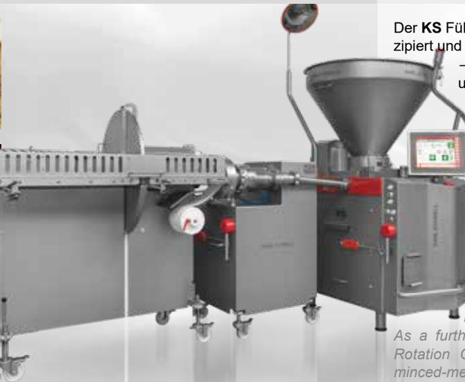
Der **KS** Füllwolf 130 ist als eigenständige Maschine konzipiert und verfügt über einen eigenen Antrieb. Er bietet – ideal zur Verarbeitung von Schweine-, Rind- und Geflügelfleisch – vielfältige Möglichkeiten, mehrere Arbeitsgänge zu vereinen.
